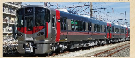
●227系(レッド ウイング) Red Wing(レッドウイング)の愛称で平成27年春に登場した車種。ステンレスの車体に赤のアクセントが特徴です。
